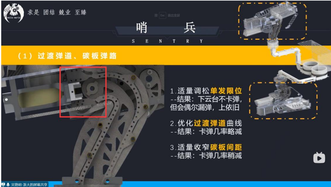
图 1.2.2 浙江大学 HelloWorld 战队 2022 开源哨兵机器人 [3] 上云台供弹链路部分细节
